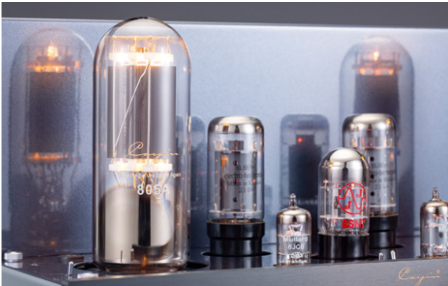
Der Jazz 100 verwendet eine echte Single-Ended-Schaltung mit je einer 805A-Endröhre pro Kanal und erzielt dennoch beeindruckende 35 Watt Leistung im Class-A-Betrieb
