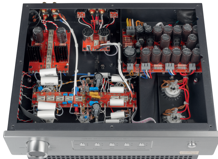
Der Aufbau erfolgt größtenteils platinengebunden, die Röhren sind jedoch direkt mit dem Chassis verbunden
