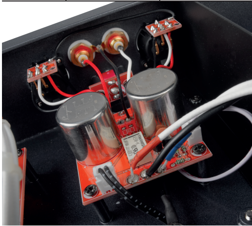
Die beiden Übertrager sorgen für die symmetrischen Ausgangssignale
