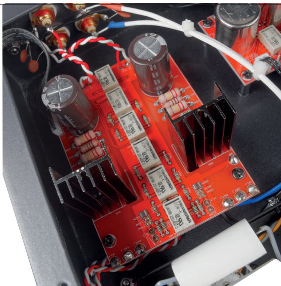
Signale werden in dem Gerät grundsätzlich per Relais vor Ort geschaltet
