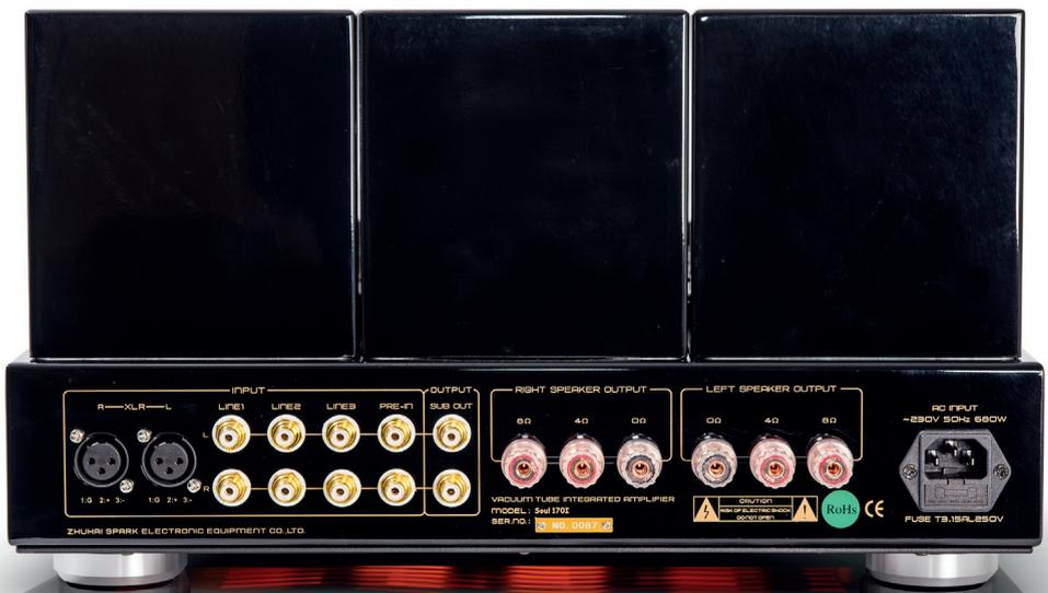
Das gesamte hintere Anschlussfeld ist belegt. Sogar ein XLR-Line-Eingang, ein Vorstufeneingang, wenn man den Soul 170i als reine Endstufe einsetzen will, sowie ein „SUB OUT“ zum Einschleifen eines Subwoofers finden sich
