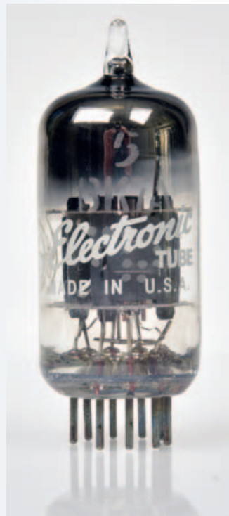
Die Doppeltriode 5BK7A stammt aus der TV-Technik und weist eine 4,7-Volt-Heizung auf.
