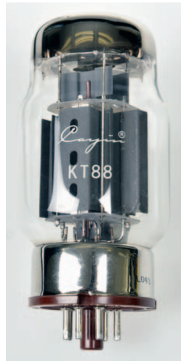
In den Oktal-Keramikfassungen stecken vier KT88-Endröhren mit „Cayin“-Aufdruck.
