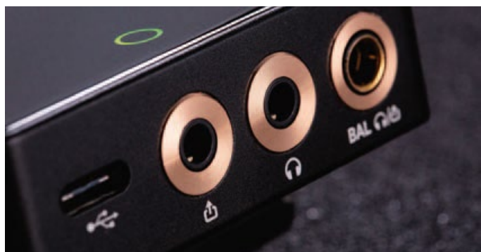
Das Triple gewonnen: Per 3,5er-Klinke können wir hinein, in der Mitte heraus und ganz rechts sogar ein Balanced-Signal abzapfen.
