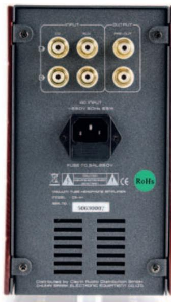
Zwei analoge Quellen finden Zugang zum Verstärkertrakt. Bei Bedarf kann man das vorverstärkte Signal an eine Endstufe weitergeben.
